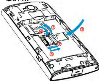
6. 取出SD卡,如图中①所示的方向推动SD卡
