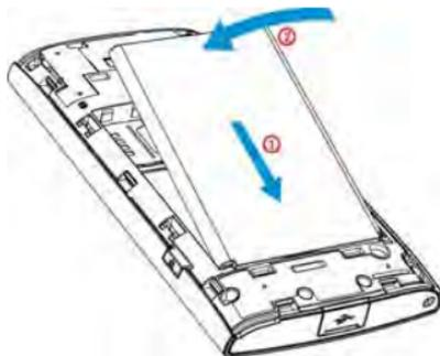
8. 如图所示插入电池后盖,然后向下扣上电
