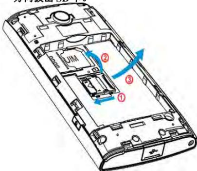
7. 如图①所示拿住电池,将电池顶端的导轨插入
