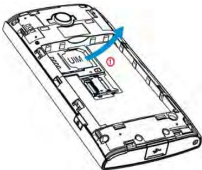
5. 插入SD卡,如图中①所示的方向滑动SD卡架
